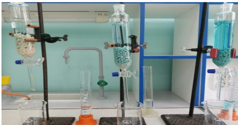
Рисунок 6 – Эксперимент с иммобилизованными сорбентами (сферы биосорбента в колонках при пропускании модельного раствора, содержащего ионы меди)
