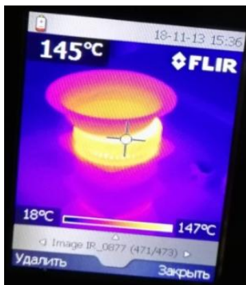
Рисунок 2 – Температурное поле установки
