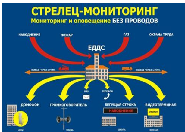
Рисунок 2 – Схема работы ПАК «Стрелец-Мониторинг» и ПАК «Радиоволна»
