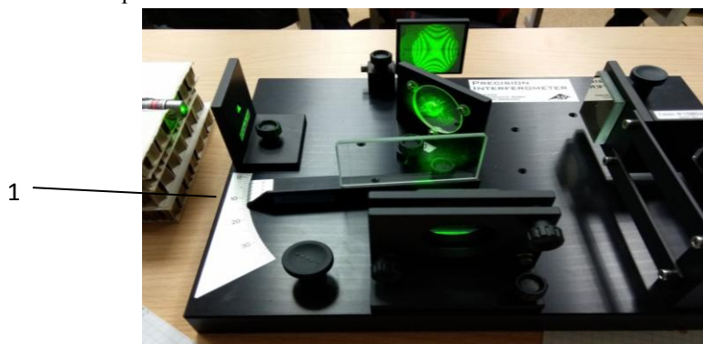
Рисунок 3 – Экспериментальная установка (1 – стеклянная пластинка на штативе)
