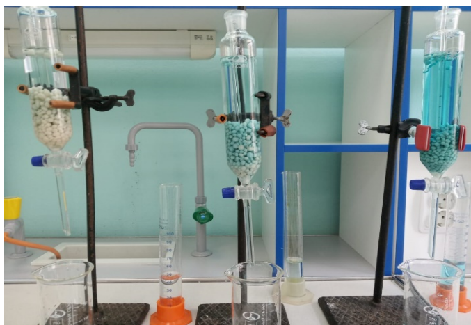
Рисунок 7 – Установка для проведения эксперимента: в колонках – сферы биосорбента; через биосорбент пропускали модельный раствор, содержащий ионы меди (II)
