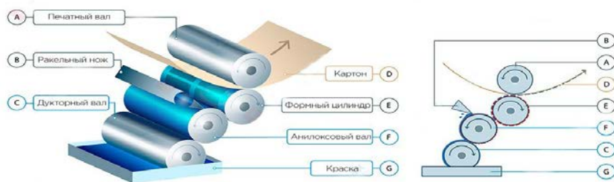
Рисунок 2 – Технология флексопечати
