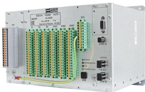
Рис. 1. УСО включают преобразователи аналоговых сигналов и преобразователи дискретных сигналов. Информация передаётся от основного оборудования к УСО по контрольному кабелю.
