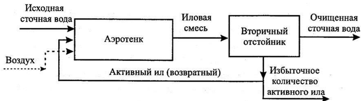
Рисунок 2 – Функциональная схема аэротенка
