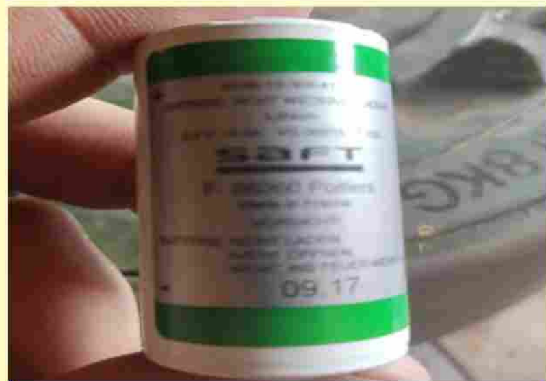
Батарея Li-Ion 3.4 вольта и 4.4 ампер часа
