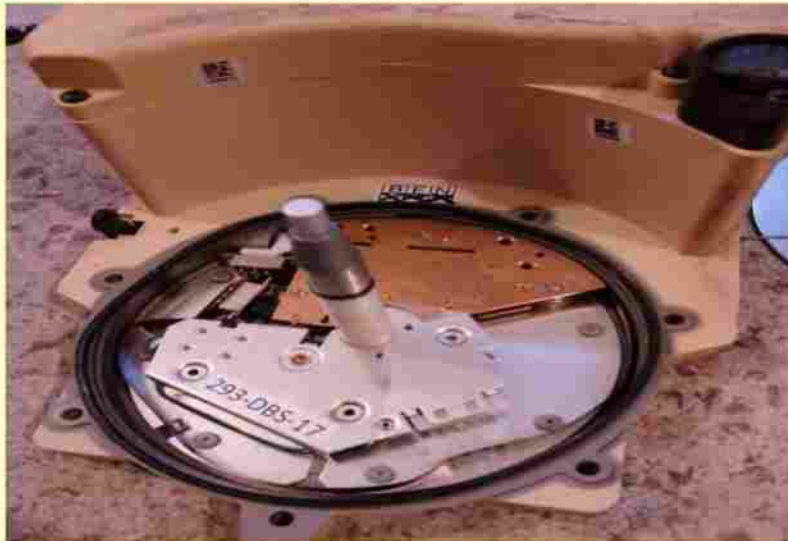
HPD 2A2 со снятым зарядом, по центру детонатор
