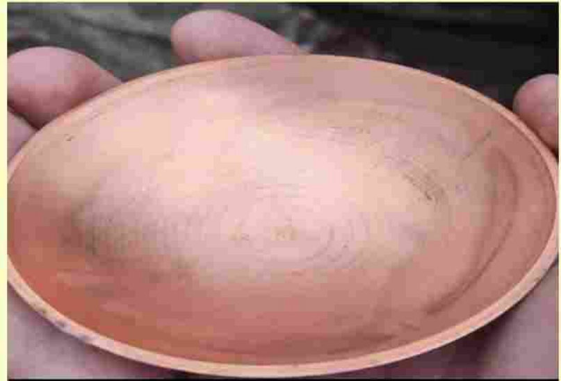
Медная кумулятивная воронка мины
