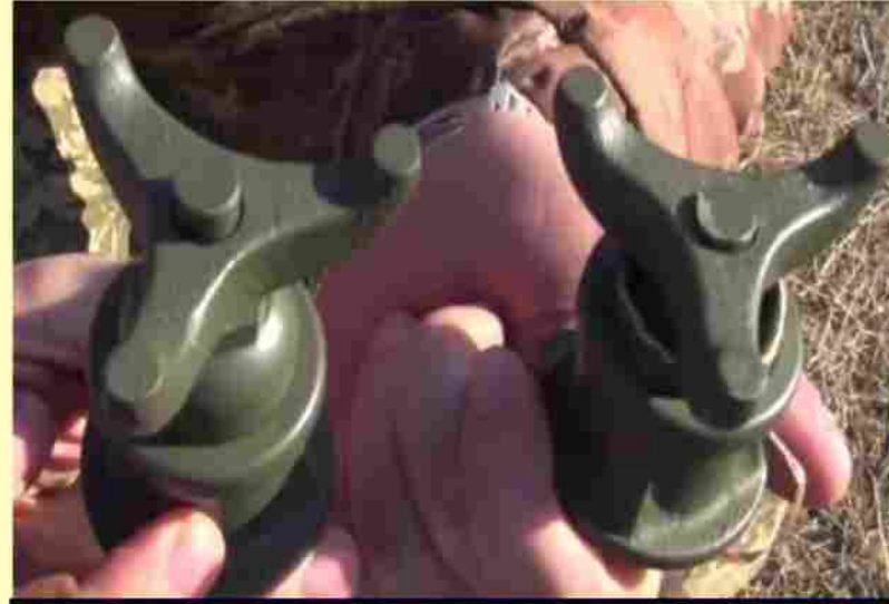
Датчики цели мины, справа сработавший (промятый)
