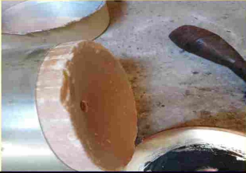
Основной заряд мины HPD 2A2 - 3 кг литого гексолита
