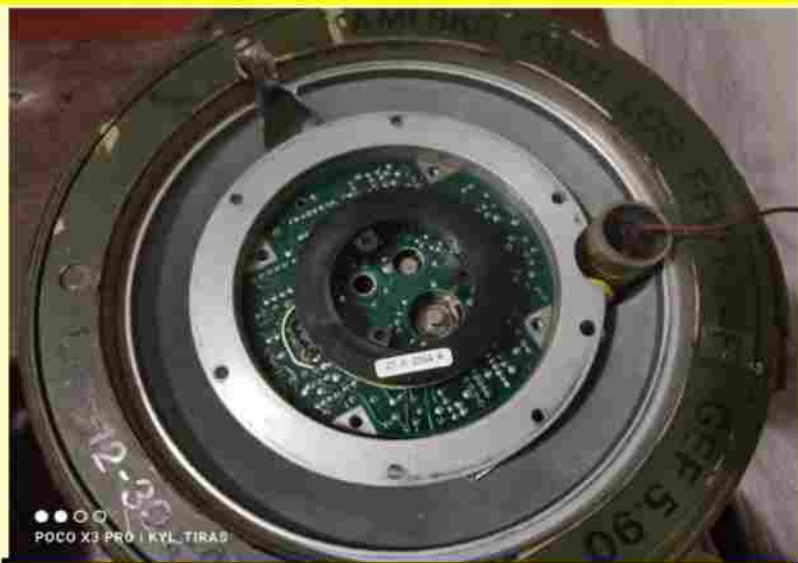
Плата управления и сигнальное устройство в корпусе
