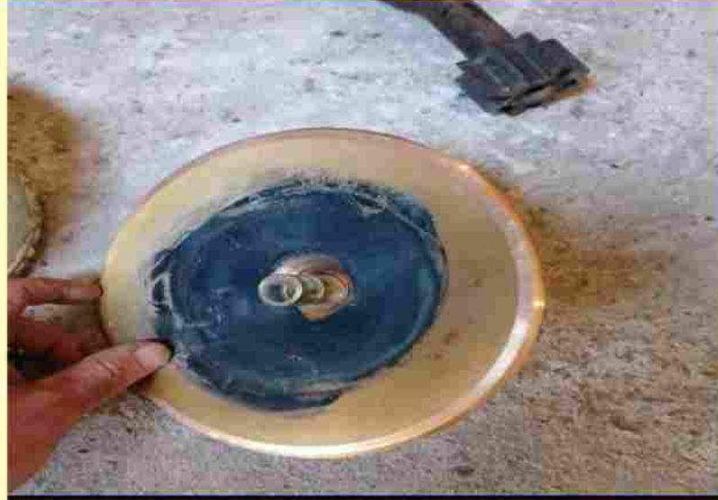
Облицовка заряда для формирования ударного ядра
