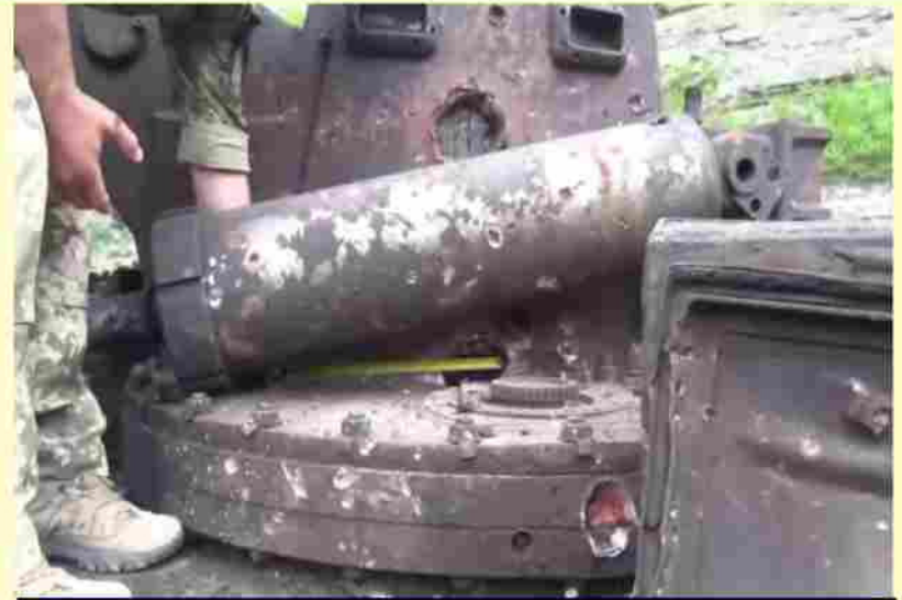
Отверстие после попадания в броне ИМР-2
