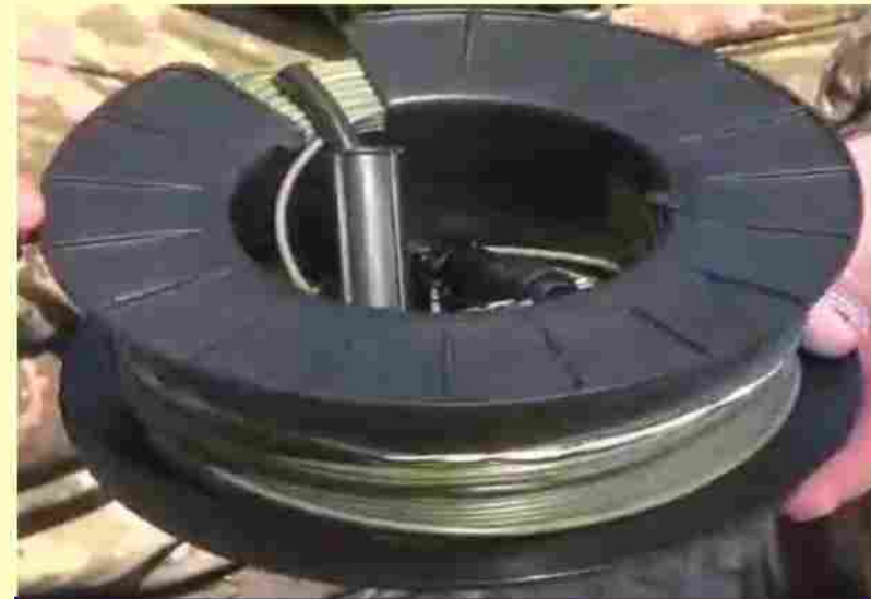
Бобина 130 м ударно-волновой-трубки с КД и иниц-ром
