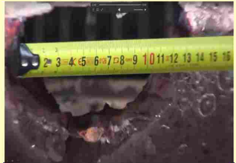
Отверстие после попадания в броне ИМР-2
