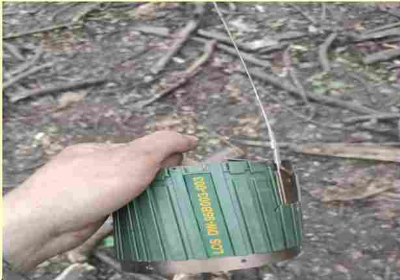
Часть корпуса мины с «антенной» -датчиком цели
