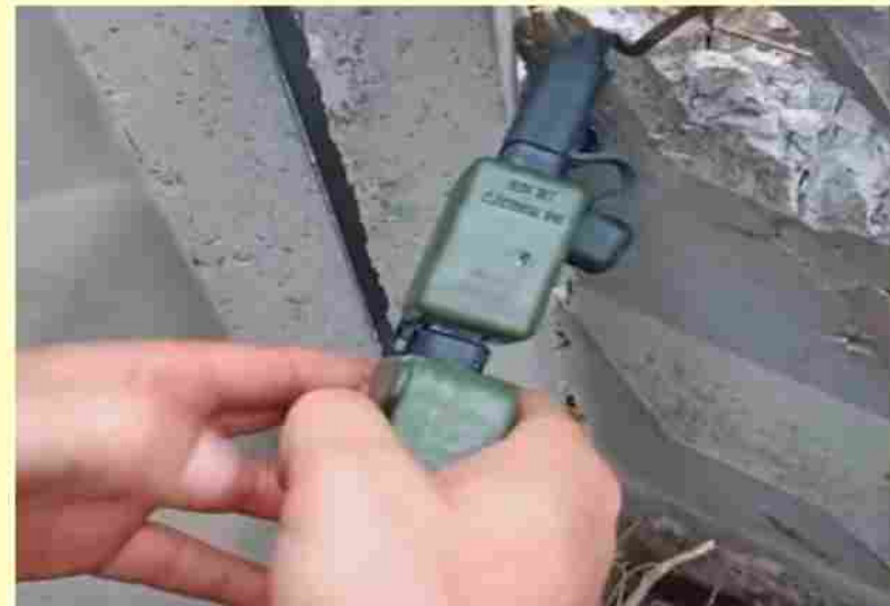
Проверочная колодка для проверки цепи
