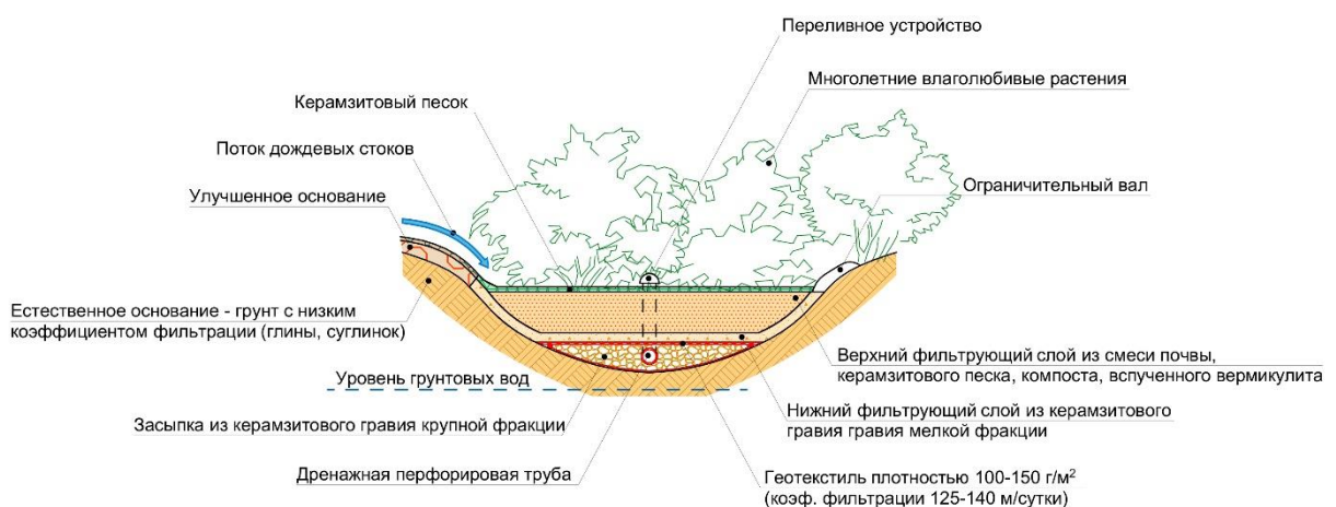
Рисунок 2 – Принципиальная схема устройства дождевого сада с дренажной системой для устройства при низком уровне грунтовых вод. Рисунок автора
