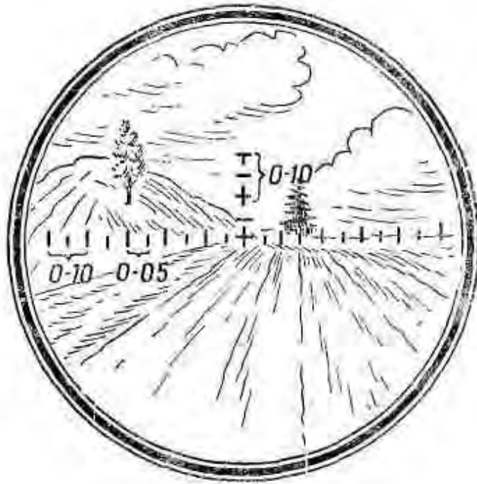
Рис.1. Измерение углов с помощью бинокля
