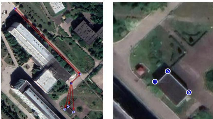
Рисунок 2 – Теодолитный ход и здание технологической подстанции
