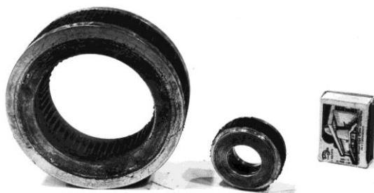
Рисунок 3 – Внешний вид опытных ТРМЭ Ду 80 мм и Ду 30 мм после формования
