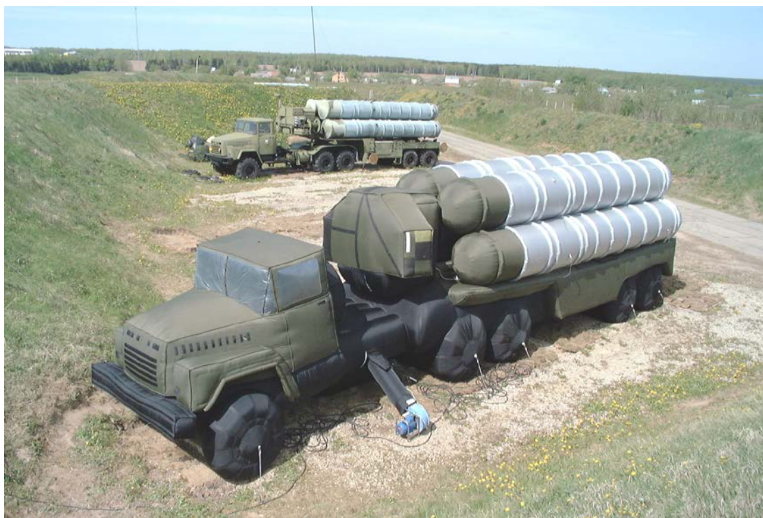
Макет ПУ 5П85 (С-300П) (реальный и макет).
