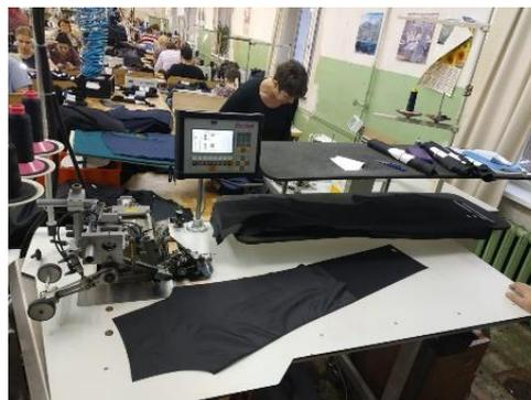
Рисунок 1 – Внешний вид швейного автомата New-tecH 1700/1 (красобметочный автомат для изготовления брюк с подкладкой)
