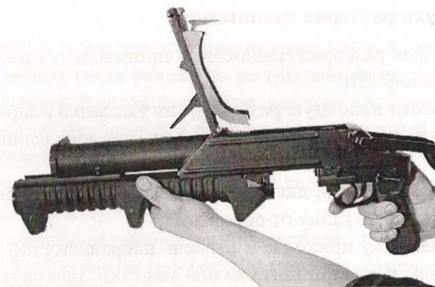
Рисунок 12. Снятие ствола с гранатомета
