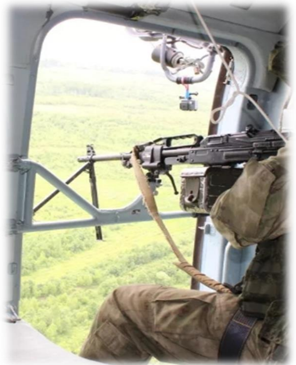
2. Установка на автоматную головку шкворневой установки (пулемет укладывается газовой трубкой или цевьем при наличии)
