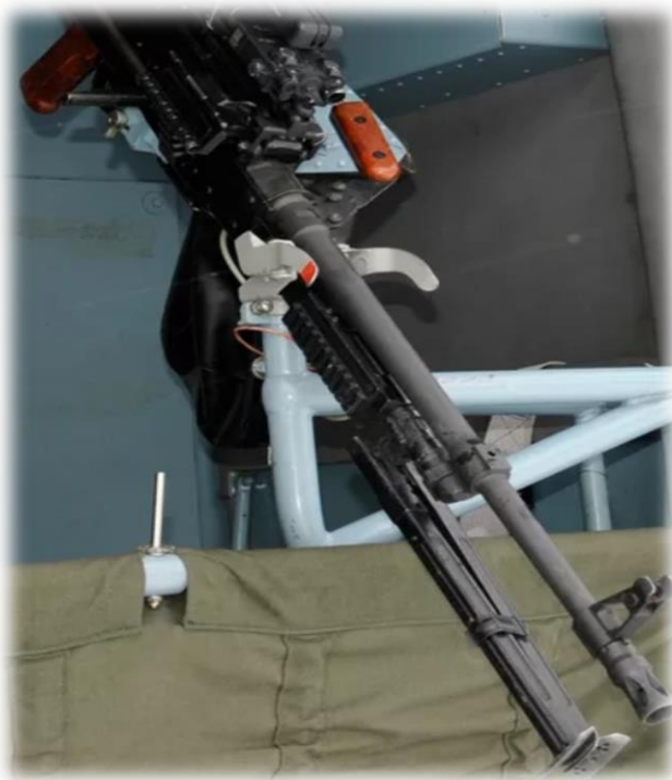
1. Установка на пулеметную головку шкворневой установки (закрепление на цапфы)
